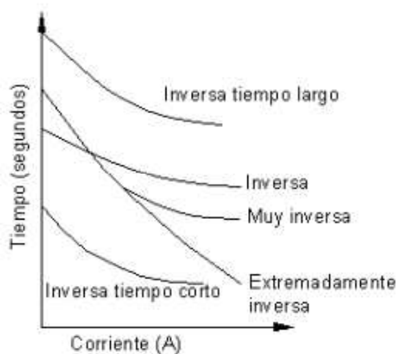
Figura 5.5: Característica de operación de relés de tiempo inverso
